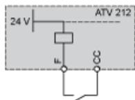
Position "PLC" avec sorties transistor de l'automate
