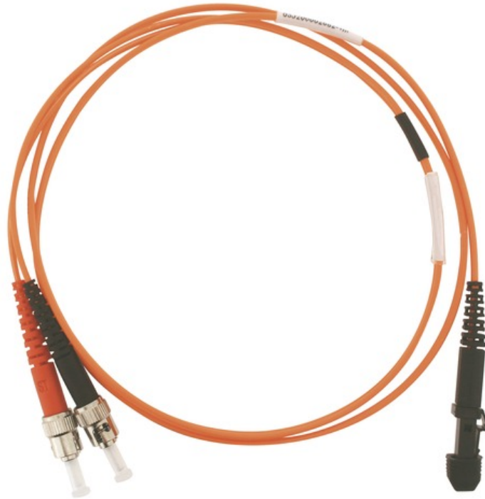
Jarretières optiques duplex OM2 50/125 \mu\text{m} , gaine orange.
