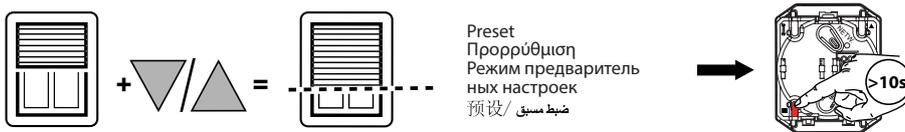
Appuyer sur la touche haut ou bas de la commande radio pour placer le volet dans la position voulue.
