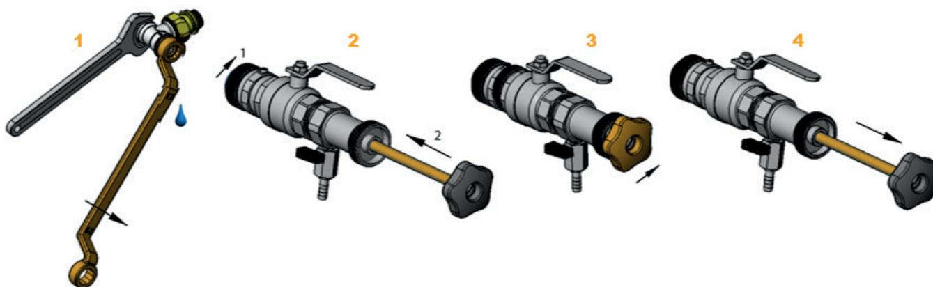
1. Dévisser légèrement le mécanisme avec une clé plate jusqu'à apparition de la première goutte.
