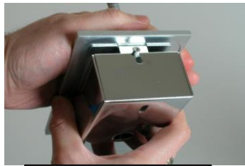
Dévisser partiellement les 2 vis
