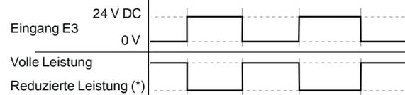
(\*) Die Höhe der Leistungsreduzierung wird bei der Konfiguration der Ladestation definiert.
